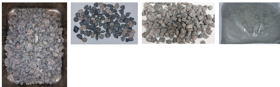
Фигура 2. Отляво надясно: а) несортиран скrap – несмлени зърна с размери около 2 cm, подаван за повторно смилане; б) сортиран скrap – стерил; в) сортиран скrap – руда; г) стрит скален материал, подготвен за химически анализ и бърза трансмисионна рентгенография
