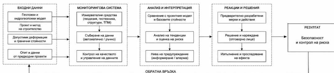
Фиг. 1. Интегрирана мониторингова рамка за активно управление на геотехническия риск.
